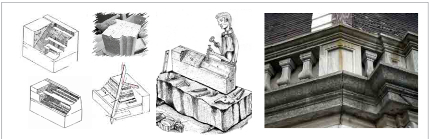
Proceso de labra de molduras (sólico capaz, talud y moldura) Plantilla, escuadra y terminación. Detalle Villa Kelmis, Mar del Plata
