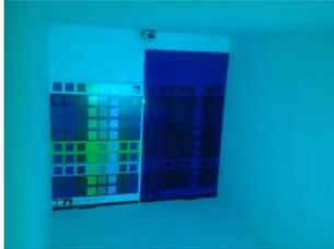
*Imagen 126: Dos muestras de colores observadas con luz roja. A una de las muestras se le suma la superposición de un filtro azul.*
