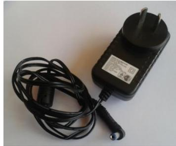
Imagen 42: Fuentes de alimentación para LED: Entrada 220V – Salida 12 V
