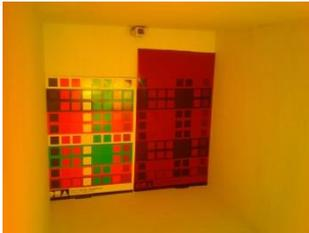
*Imagen 116: Las mismas dos muestras de colores observadas con luz azul. A una de las muestras se le suma la superposición del mismo filtro rojo.*
