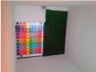
*Imagen 109: Dos muestras de colores observadas con luz blanca generada por la sumatoria de luces R-G-B. A una de las muestras se le suma la superposición de un filtro verde.*
