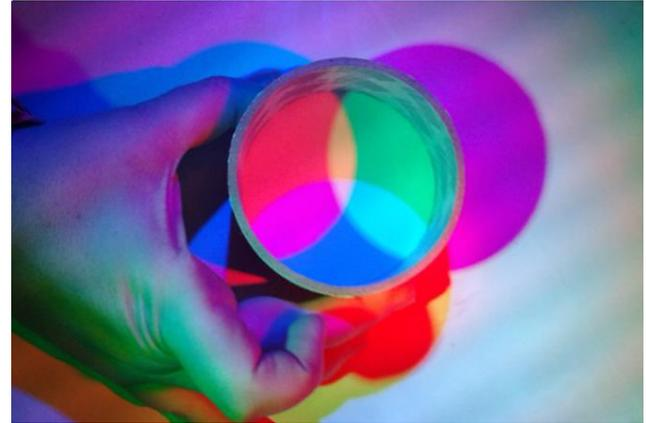
*Imagen 9: Colores producidos por la mezcla de tres fuentes de luz cada una de color rojo, verde y azul (RGB). En las intersecciones de las sombras producidas por la interposición de un objeto cilíndrico, se pueden observar los colores primarios aditivos (RGB), las mezclas de dos primarios produciendo el cian (G+B), el magenta (R+C) y el amarillo (R+G), y las mezclas de los tres primarios generando el blanco.*
