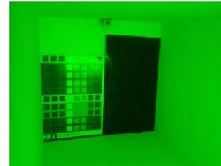
*Imagen 112: Las mismas dos muestras de colores observadas con luz verde. A una de las muestras se le suma la superposición del mismo filtro rojo.*
