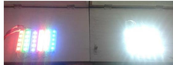
Imagen 45: Disposición de los LEDs en ambas cajas sobre las tapas delanteras abiertas. A la izquierda RGB, a la derecha luz blanca.
