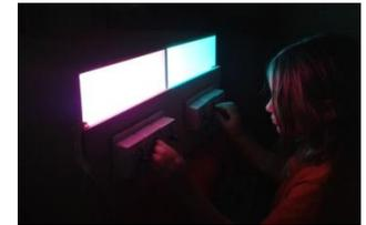
Imagen 58: Observador interactuando con las dos caja. Ubicación a la altura media entre ambos visores y con las manos dispuestas en los DIMMER.
