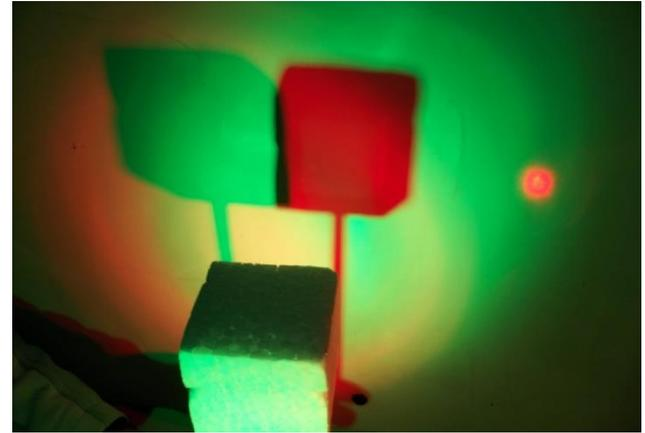
*Imagen 21: La sumatoria de dos fuentes de luz primarias: rojo y verde ( $R+G$ ) da como resultado una luz AMARILLO que se puede observar en el fondo más luminoso. En las sombras del objeto interpuesto arrojadas sobre el fondo se pueden ver cada uno de los colores de las fuentes de luces utilizadas y en la intersección de ambas sombras se puede observar el negro por la ausencia de luz.*
