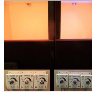
*Imagen 98: Otra igualación de pigmento y luz. En los dimmer se puede observar la conformación de cada mezcla de luz de luz de RGB.*
