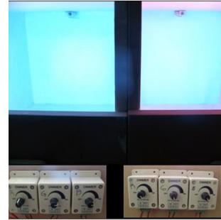
*Imagen 94: Otra igualación de pigmento y luz. En los dimmer se puede observar la conformación de cada mezcla de luz de RGB.*
