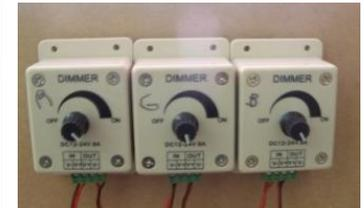
Imagen 38: Disposición de cada DIMMER al frente de la tapa delantera
