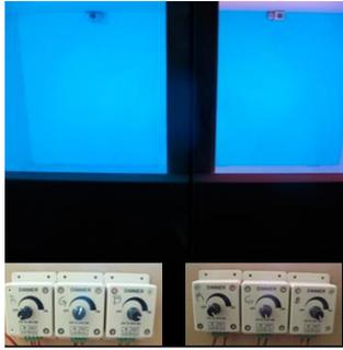
*Imagen 96: Otra igualación de pigmento y luz. En los dimmer se puede observar la conformación de cada mezcla de luz de RGB.*
