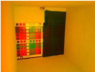
*Imagen 122: Las mismas dos muestras de colores observadas con luz azul. A una de las muestras se le suma la superposición del mismo filtro verde.*
