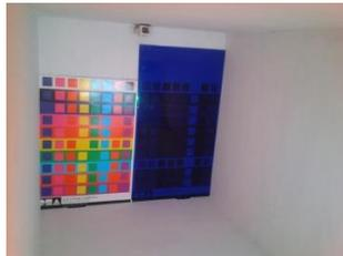
*Imagen 110: Dos muestras de colores observadas con luz blanca generada por la sumatoria de luces R-G-B. A una de las muestras se le suma la superposición de un filtro azul.*
