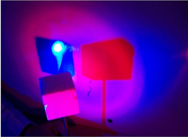
*Imagen 20: La sumatoria de dos fuentes de luz primarias: rojo y azul ( $R+B$ ) da como resultado una luz MAGENTA que se puede observar en el fondo más luminoso. En las sombras del objeto interpuesto arrojadas sobre el fondo se pueden ver cada uno de los colores de las fuentes de luces utilizadas y en la intersección de ambas sombras se puede observar el negro por la ausencia de luz.*
