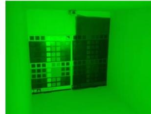
*Imagen 119: Las mismas dos muestras de colores observadas con luz azul. A una de las muestras se le suma la superposición del mismo filtro verde.*
