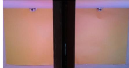
Imagen 103: Los mismos dos colores que se observaban diferentes en igual condición de luz, aquí se modificó la iluminación de la caja de la izquierda y se logró igualar ambos colores. Se igualaron por combinación de luces (R 100% - G 50% - B 75%)
