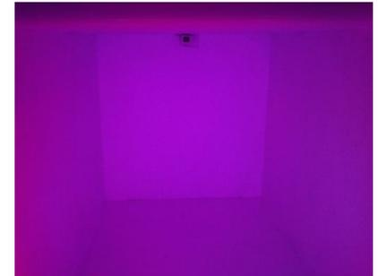
Imagen 74: Luz magenta, resultado de la sumatoria de luces roja y azul en el interior de una de las cajas.
