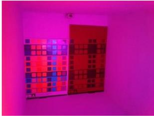
*Imagen 115: Las mismas dos muestras de colores observadas con luz verde. A una de las muestras se le suma la superposición del mismo filtro rojo.*
