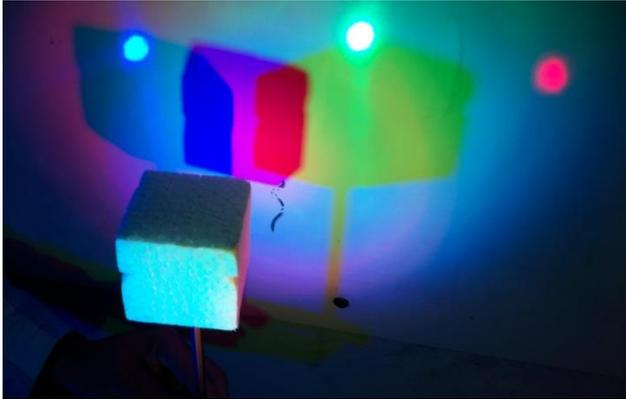
*Imagen 18: La sumatoria de tres fuentes de luz primarias: RGB da como resultado luz blanca. Al interponerle un objeto, éste sustrae luz sobre el fondo generando distintas combinaciones de colores. En las sombras del objeto interpuesto arrojadas sobre el fondo se pueden ver la mezcla de dos colores de las fuentes de luces utilizadas y en la intersección de dos sombras se puede observar el color de la luz que tienen en común ambas sombras.*
