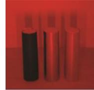
*Imagen 135: Mismos cilindros. A partir de la luz roja, más allá de la modificación del color, se puede observar que los dos de la derecha casi se igualaron en valor alto y se oscureció el de la izquierda. El brillo de este último disminuyó.*
