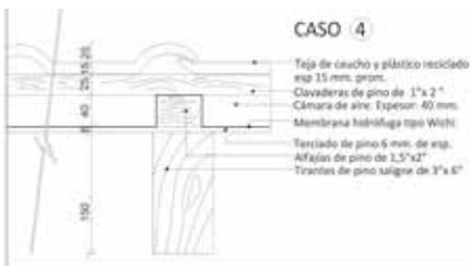
**Figura 7.** Corte constructivo de del tipo de cubierta 4.
