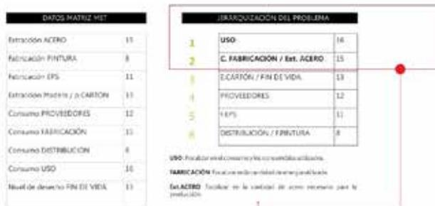
SISTEMA SIMPLIFICADO DE AGV - A fin de conseguir resultados focalizados en el problema de mayor impacto se plantea la priorización del análisis a los efectos del Consumo durante el USO del Calefactor y durante su FABRICACIÓN, estudiando en profundidad la cantidad de ACERO aplicado y la energía utilizada.
