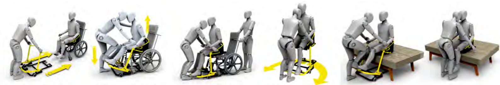
LA BASE DE MOTUS VA POR DEBAJO DE LA SILLA DE RUEDAS SE COLOCAN LOS PIES DEL PACIENTE EN LOS APOYA PIES DEL BALANCIÓN. IMPORTANTE: EL PACIENTE NO PUEDE USAR EL SISTEMA COMO UNA SEGUNDA SILLA DE RUEDAS LOS PIES DEL TERAFISTA QUEDA UNO DE CADA LADO DEL APOYA PIE SUYO
