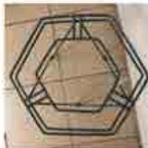
El producto consiste en tres exágonos y tres triángulos invertidos. Desde la vista superior se puede apreciar como las tres patas conectadas forman un triángulo circunscrito en el hexágono.
