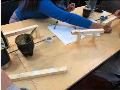
Figura 5. Uniones de cinta adhesiva en estructuras de Jenga a Flexión.
