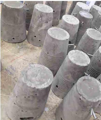
Figura 4.c.2 Desmolde de las pesas
