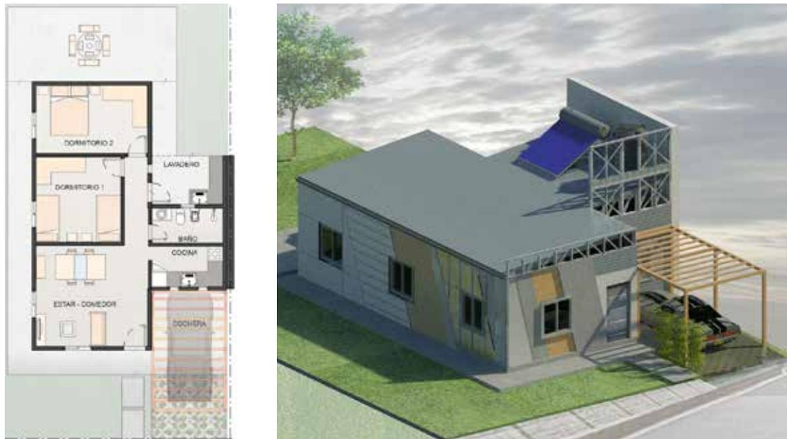
Figura 2: a la izquierda planta arquitectónica base y a la derecha axonométrica de la resolución tecnológica adoptada. Fuente: Arengo y Breard, 2018.
