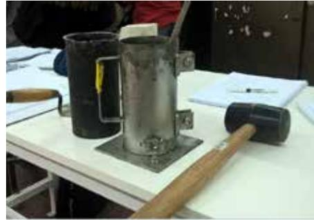
Figura 2. Moldes para probetas.
