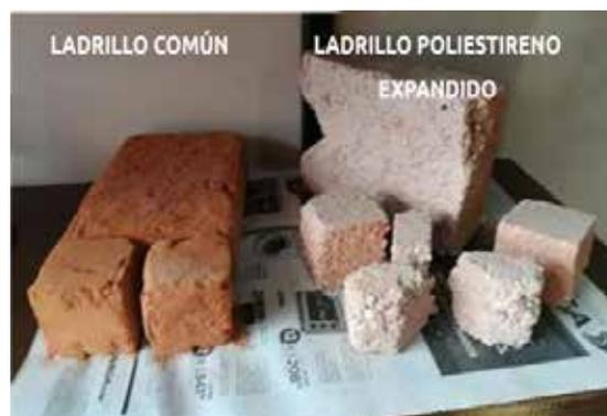
Fig. 3 Comparación ladrillo común y ladrillo con poliestireno expandido
