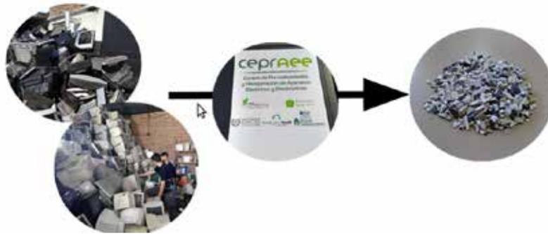
Fig. 2 Proceso de revalorización del Plástico por realizado en el Centro de Pretratamiento y Revalorización de AEE
