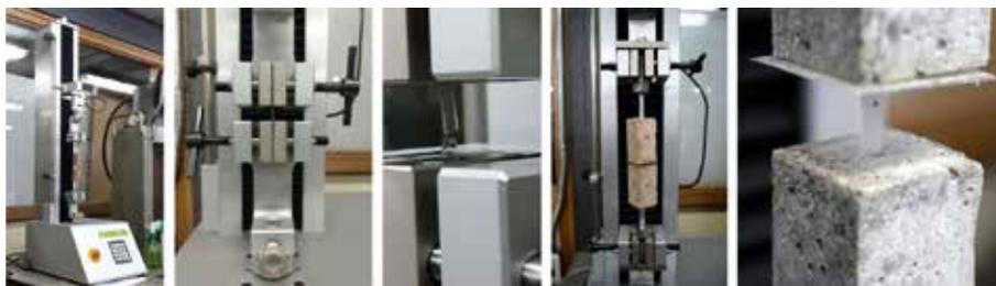
Fig. 4 Equipos y muestras de ensayos. De izquierda a derecha: vista general del equipo, colocación de fibra para tracción, fibra ensayada a tracción, colocación de probeta para pull out y fibra ensayada a pull out.
