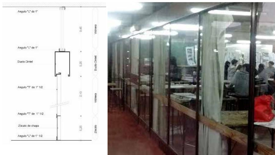
Fig. 8 Detalle de sistema de cierre interiores y carpintería
