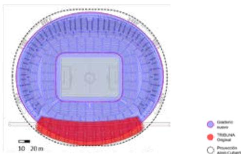
Figura 5: Esquema de ampliación de estadio. Planta.
