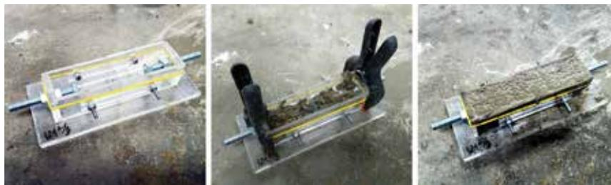
Fig. 3 Proceso de llenado del molde para ensayo de pull out. De izquierda a derecha: posicionado de la fibra, etapa intermedia en el llenado del molde, molde enrasado.
