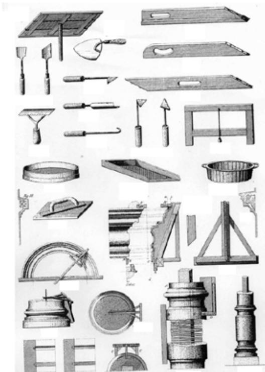
Figura 6, herramientas particulares pero sencillas utilizadas en la ejecución del mortero in situ, tanto para la ejecución de almohadillados como de molduras. Imagen archivo personal F.P.B.
