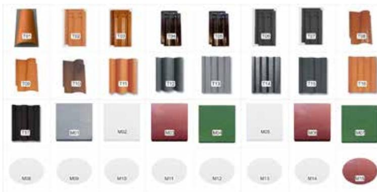
**Figura 1.** Imágenes de los materiales de techos evaluados. Tejas tradicionales -cerámicas y cementicias- (T01 a T16) y con compuesto reciclado (T17); membranas asfálticas –aluminio y geotextil- (M01 a M07) y líquidas (M08 a M15).
