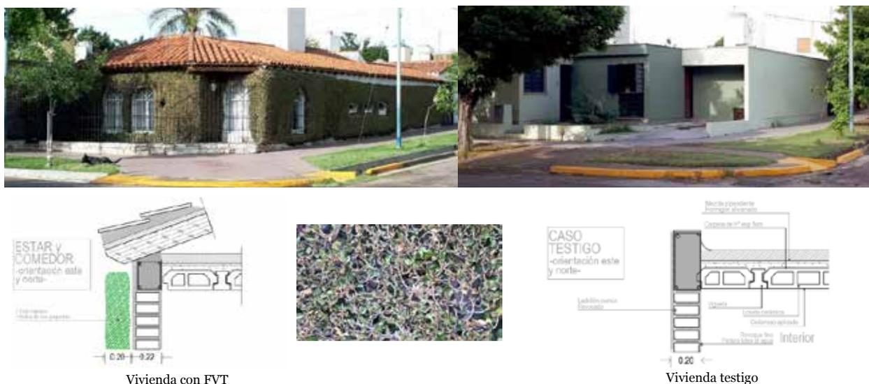
Figura 4 – Caso II vivienda en una planta: Vivienda con FVT y Vivienda testigo; Paquetes tecnológicos.
