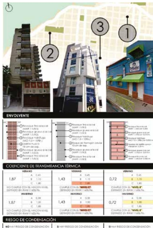
Fig. 1: Tabla síntesis de los edificios- caso seleccionados y características de sus muros. Fuente: elaboración propia.
