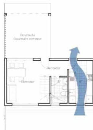
Figura 8- Esquema ventilación con aberturas en paredes opuestas desfasadas
