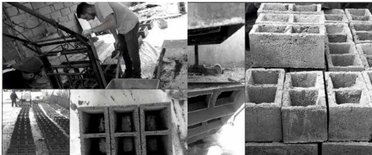
FIG 4 – Bloquera previo ajuste - Bloques deficientes. FIG 5 - Bloquera reparada – bloques óptimos.
