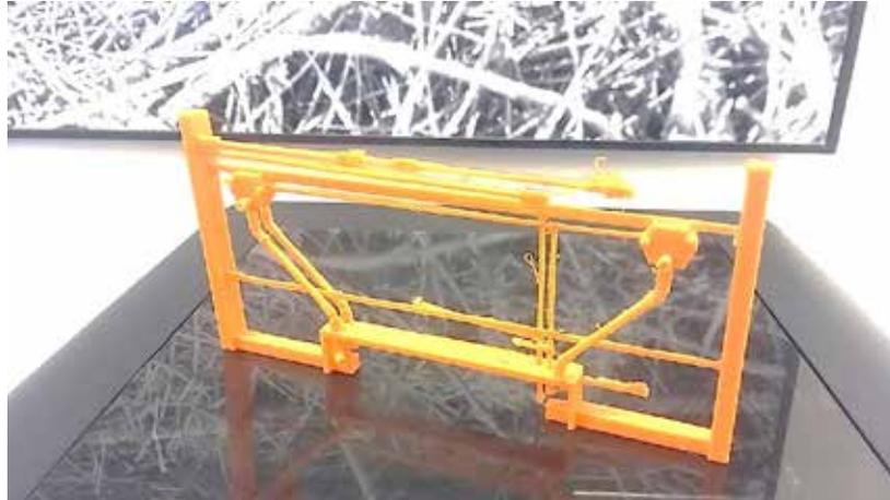
Fig.12 –Parcialidad de Prototipo “A” impreso tridimensionalmente a escala en ABS
