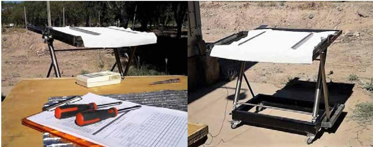
Figura 1: equipo para la determinación de la transmitancia visible.
