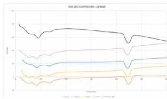
Figura 2. DTA de pastas de cemento con 10% de sustitución cerámica a 28 días.
