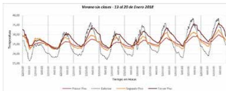
Fig. 11 Comparación de temperaturas interiores y exteriores en diferentes pisos. Verano.
