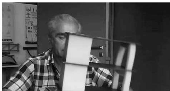
Fig. 8. Probando modelo en mesa vibratoria
