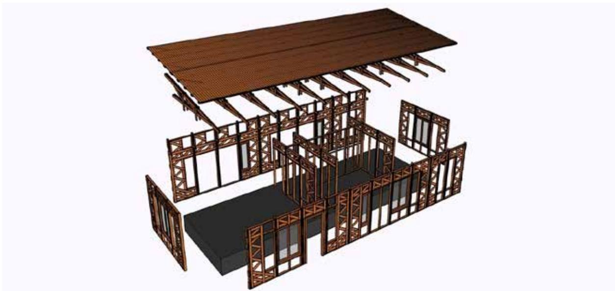
Fig. 7: Despiece de los componentes (paneles, cabriadas y columnas) del sistema constructivo “Concordia”.
