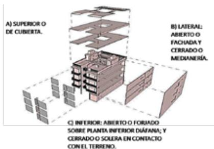
Figura 2. Subsistemas, componentes, partes constitutivas de la envolvente
