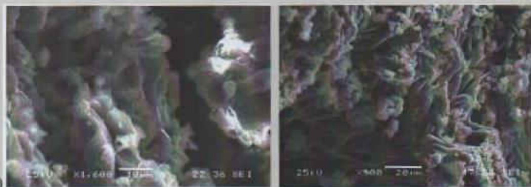
Figura 2.15 Observación en MEB de la textura de morteros: a) De cal, b) De yeso. Junta de Andalucía. Programa de normalización de estudios previos aplicadas a bienes inmuebles. 2006
