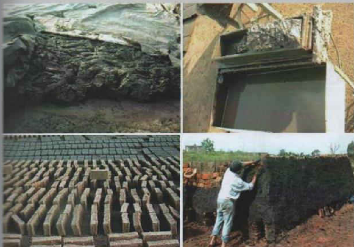
Figura 2.2 Proceso productivo de mampuesto cerámico (ladrillo de campo) artesanal en Uruguay: mezclado y conservación de la mezcla, moldeado, secado natural y construcción del horno con las piezas crudas y recubrimiento de barro.
