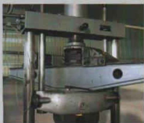
Figura 5.14 Ensayos en morteros: a) Ensayo de flexión, b) Ensayo de compresión. Laboratorio del Instituto de Ensayo de Materiales, Facultad de Ingeniería, c) Equipo Pendulum Hammer .
