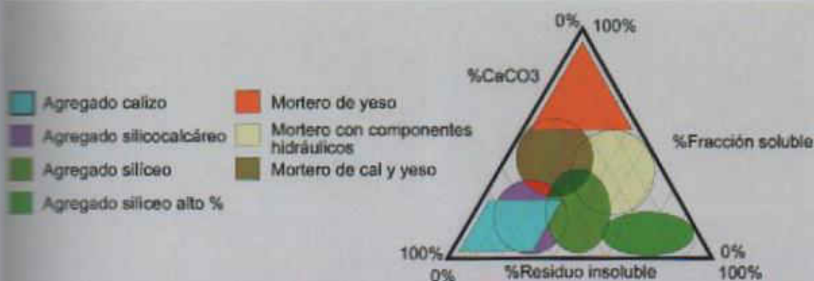
Figura 2.13 Método de clasificación de morteros según fracción soluble tras ataque con HCl, residuo insoluble y contenido de carbonato de calcio. Fuente: J. Ignacio Álvarez Galindo. Morteros. Programa de normalización de estudios previos aplicados a bienes inmuebles. España, 2006. Página 109.
