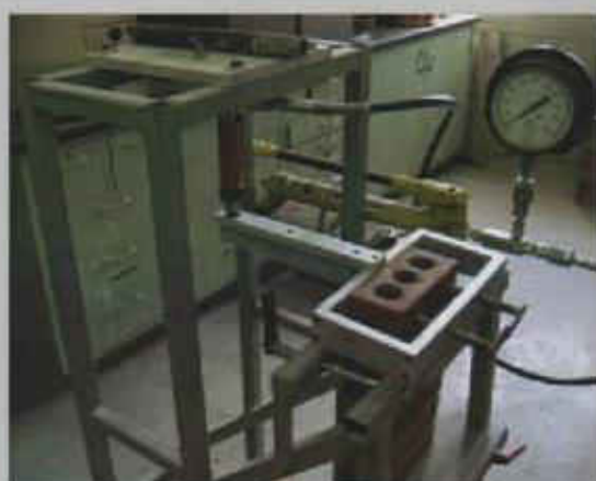
Figura 5.15 Ensayos de interfase: a) Ensayo de adherencia in situ , b) Ensayo de adherencia en laboratorio. Fuente: M.P. Schuller 7 .
