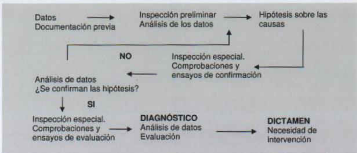
Figura 5.1 Diagrama del estudio patológico, según norma UNE-EN 41805, Parte 3.
