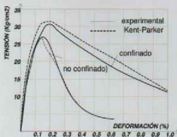
Figura 3.36 Diagrama de Tensión – deformación: a) Curva tensión-deformación obtenida por Kent y Park, con el ajuste realizado por Priestley-Elder 36 y b) Curva admitida en reglamento DBSE-F, trazado b o c, España 2006
