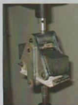
Figura 5.14 Ensayos en morteros: a) Ensayo de flexión, b) Ensayo de compresión. Laboratorio del Instituto de Ensayo de Materiales, Facultad de Ingeniería, c) Equipo Pendulum Hammer .
