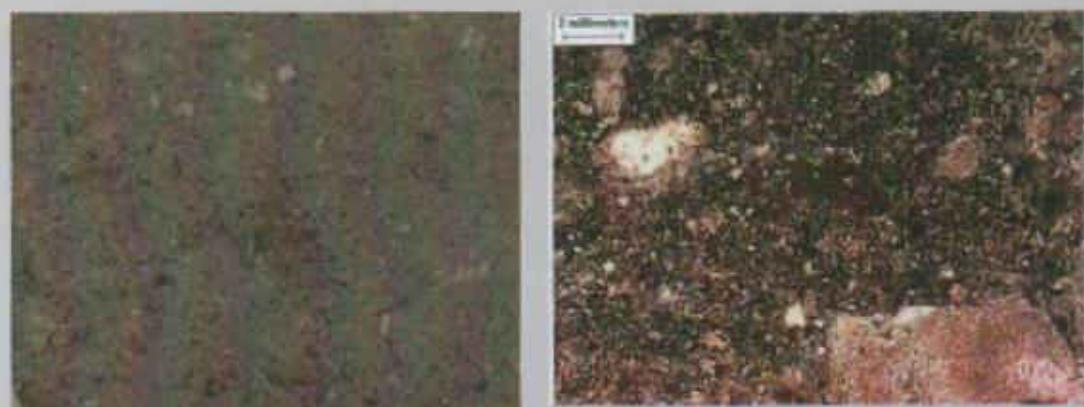
Figura 2.16 Mortero de junta de muros de Capilla en Calera de las Huérfanas, Carmelo, aspecto a simple vista y microfotografía en laboratorio. LEMIT.
